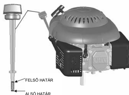
AZ OLAJBEÖNTŐ FEDELE – OLAJMÉRŐ LÉC
